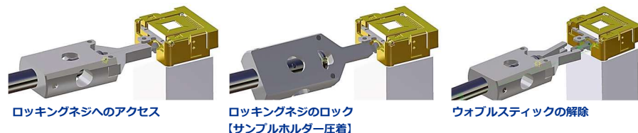
ロックネジのロック 【サンプルホルダー圧着】
